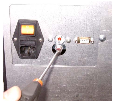
Abb. 25 - Rücksetzung des Kolbenfühlers nach Abkühlung des Ofens
