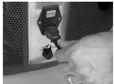
Elektrischer Anschluss des Heizofens
