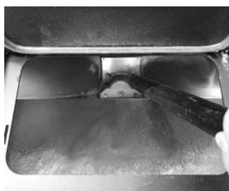
Fig. 35 - Nettoyage réservoir et vis sans fin
