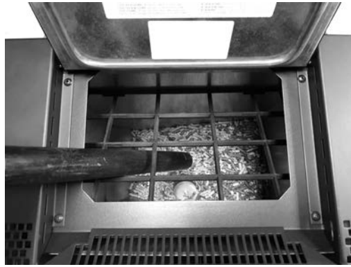
Fig. 29 - Limpieza depósito y coquea
