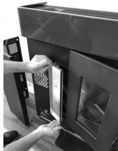
Fig. 31 - Desmontaje del panel de inspección
