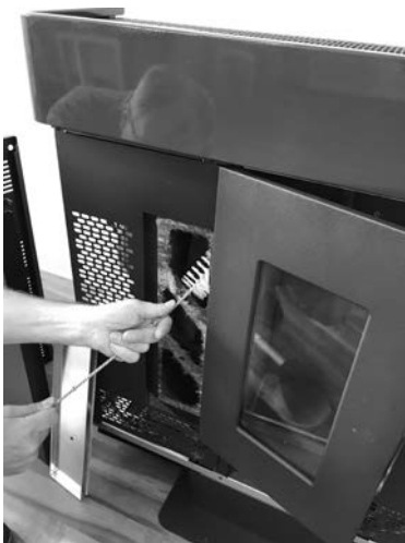
Fig. 32 - Limpieza con escobilla
