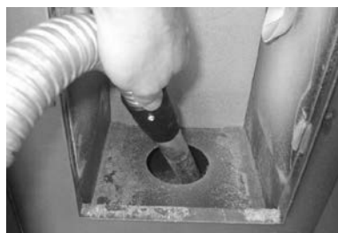
Fig. 27 - Limpieza alojamiento brasero
