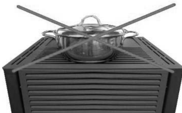
Fig. 25 - Non coprire le feritoie dell'aria
