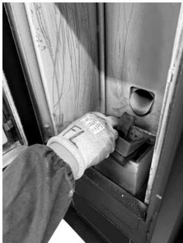
Fig. 27 - Extraction de le brasero
