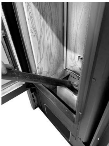
Fig. 29 - Nettoyage l'espace du brasero
