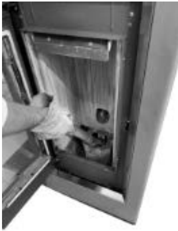
Fig. 35 - Limpieza alojamiento brasero
