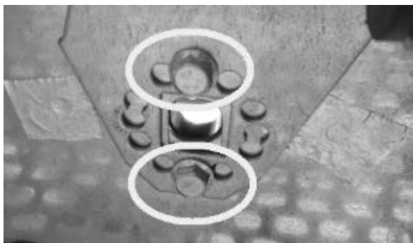
Fig. 35 - Die Schrauben entfernen
