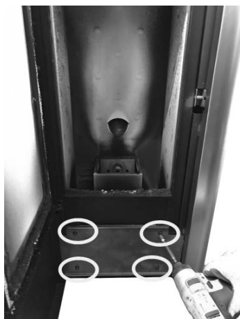
Fig. 29 - Die Schrauben entfernen
