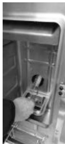
**Fig. 35 - Nettoyage avec nettoie-pipes**
