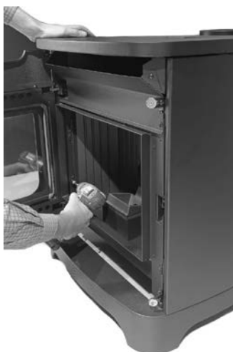
Fig. 38 - Retirer les fontes latérales
