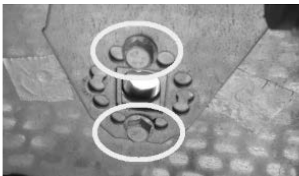
Fig. 41 - Retirer les vis
