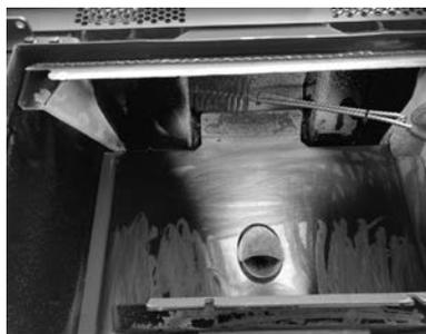
**Fig. 28 - Mit einer Rohrreinigungsbürste reinigen**
