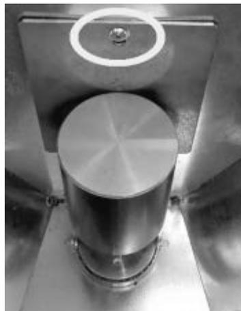
*Fig. 33 - Entfernen der Schraube*
