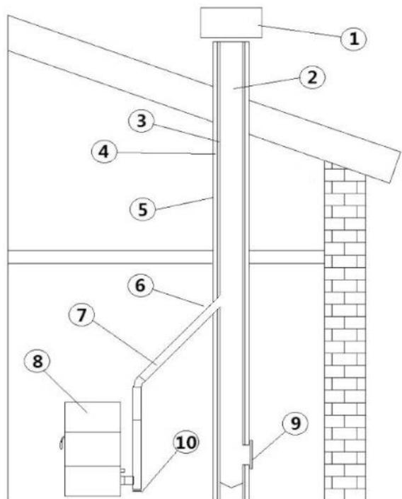
**Fig. 2 - Bauteile Kamin**
