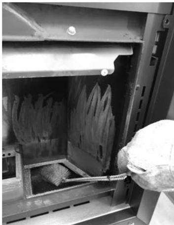
**Fig. 26 - Mit einer Rohrreinigungsbürste reinigen**
