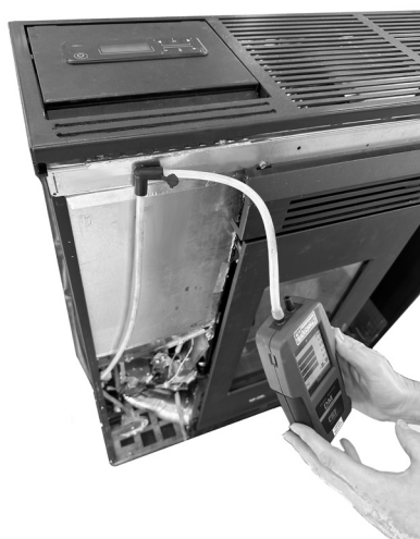
Fig. 45 - Collegamento pressostato digitale
