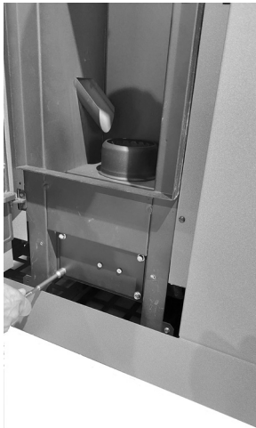
Fig. 60 - Remove the cap
