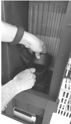
Fig. 47 - Remove the burning pot
