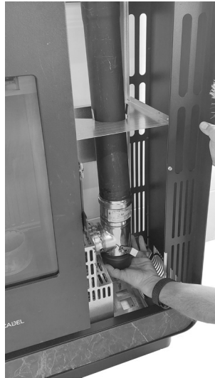
Fig. 56 - Limpieza canal de humos
