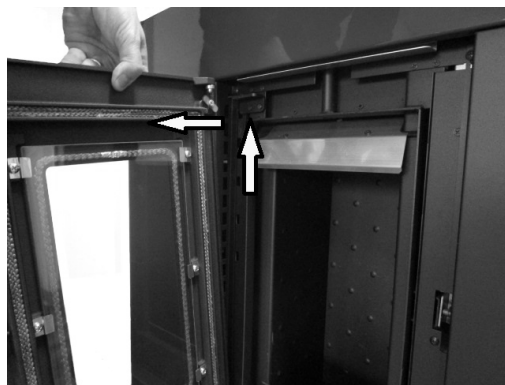
Fig. 27 - Desmontaje de la puerta
